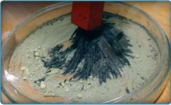
Demir tozları kükürt tozundan mıknatısla ayrılır.
